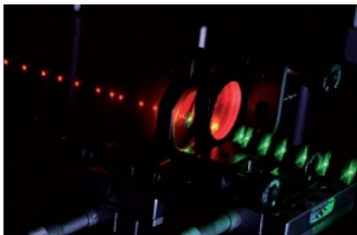
Exemple de laser pulsé à colorant solide. En vert, le laser de pompe, et, en rouge, le faisceau laser produit par une couche d'épaisseur micrométrique de polymère, dopé avec de la rhodamine. © IPL, S. Forget
